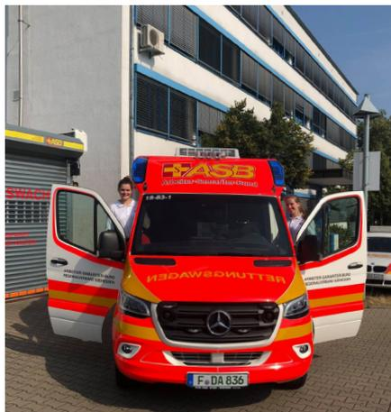
Das Fahrzeug wurde auf einem Mercedes Sprinter 319 CDI aufgebaut. Es wurde unter anderem mit einem 230 V-Stromwandler ausgestattet, der eine Versorgung der Patienten mit modernstem technischen Gerät ermöglicht. Die Klimaanlage auf dem Dach soll für einen kühlen Kopf unserer Mitarbeitenden sorgen.
